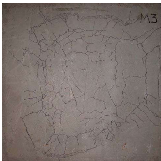
Рис. 3. Образец в [7] после разрушения. Растянутая грань
